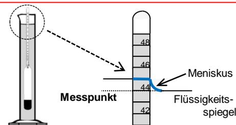
Figur 1: Flüssigkeitsspiegel = Messpunkt
