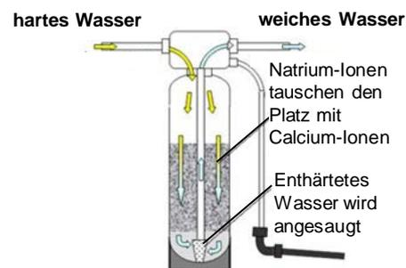
Figur 2: Funktion eines Ionentauschers
